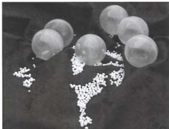
Abb. 3 Grösse & Material der Kugeln in der Decke variieren je nach Anwendung.
